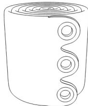
Гибкая армированная ПВХ-труба 100 мм, L = 3 метра, с люверсами для крепления к воронке желоба – 1 шт.
