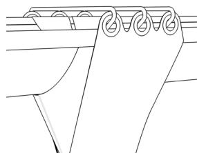
Соедините отверстия при помощи металлических П-образных скоб.
