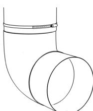
С обратной стороны гибкой ПВХ-трубы вставьте отвод и зафиксируйте его при помощи хомута-стяжки.
