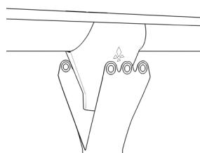
Расправьте гибкую ПВХ-трубу с той стороны, где находятся отверстия под крепление и натяните на водосточную воронку.
